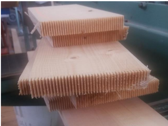
(a) Finger Joint para la unión de trozos de madera
