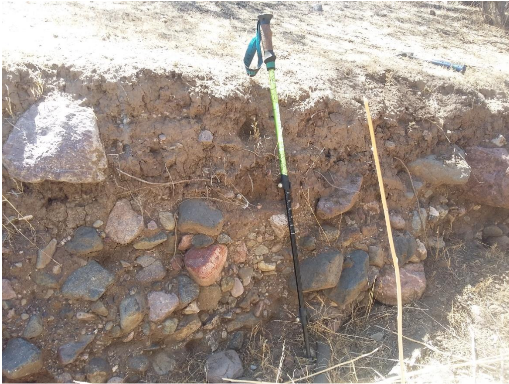
Figura 5.5: Depósito fluvial polimíctico, matriz soportados por una grava arenosa, con clastos redondeados a subredondeados de hasta 60 cm de diámetro. El depósito varía entre 1.5 a 2 metros de espesor.
