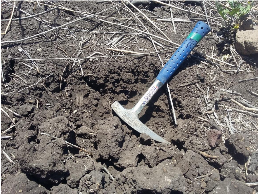
Figura 5.4: Depósito coluvial con gravas y bloques matriz soportados por una arcilla-limosa. Clastos de entre 4 a 20 cm de diámetro.
