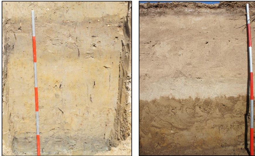
Figura 5.11: Ejemplos de depósitos de grano fino masivos. A la izquierda foto del perfil PCÑ y a derecha foro del perfil PCH.
