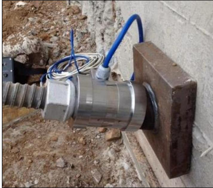
Figura 2.21 Celda de carga de cuerda vibrante (Vásquez, 2018).
