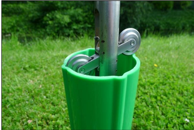
**Figura 2.19 Tubería y sonda inclinométrica (Gouda Geo-Equipment B.V.).**
