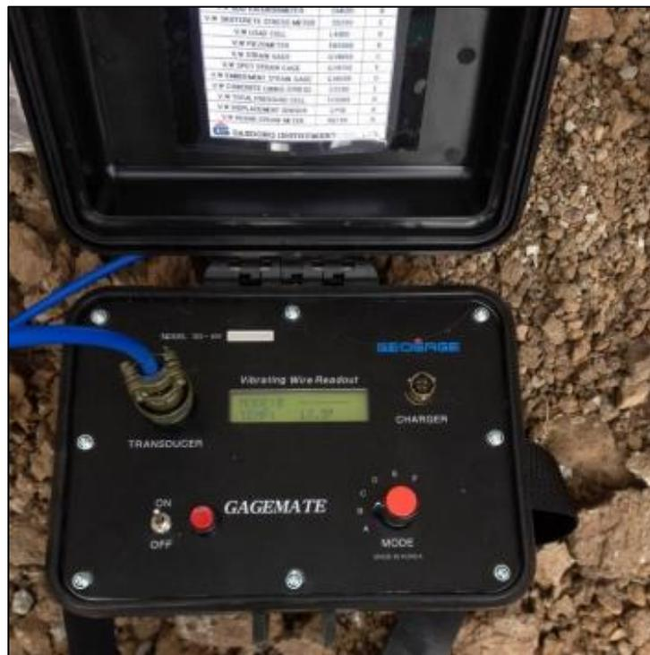
Figura 2.24 Unidad de lectura de cuerda vibrante para celda de carga (Vásquez, 2018).
