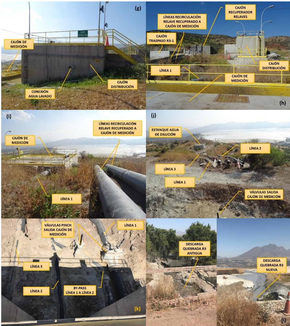
Descripción: (g) vista cajón de distribución. (h) vista del cajón de distribución, recuperador relaves deripiados, cajón de medición. (i) recirculación relaves desripiados a primer compartimiento cajón de medición. (j) vista ubicación línea 1, línea 2 y línea 3. (k) vista de válvulas pinch de cajón de medición y by-pass Línea 1. (l) descarga quebrada R3 antigua y R3 nueva.
