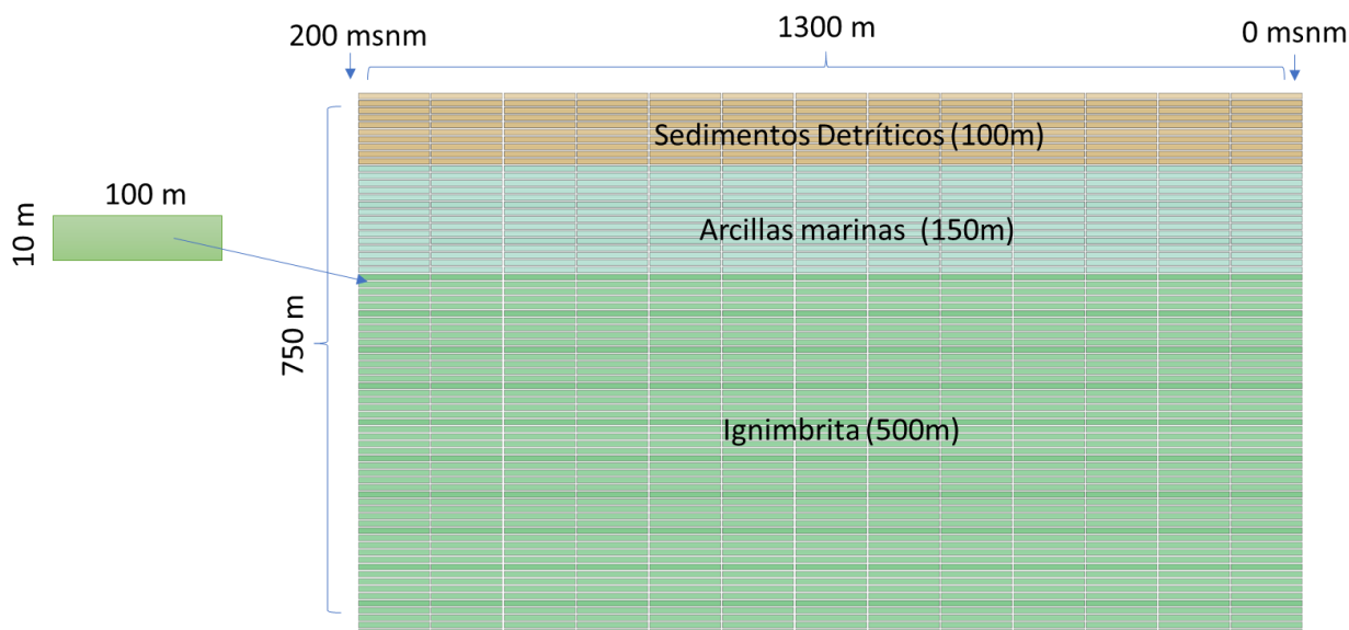
Figura 11 Estructura del Modelo Numérico. Se define los límites y el tamaño de la grilla, donde se ubican las unidades hidrogeológicas analizadas.
