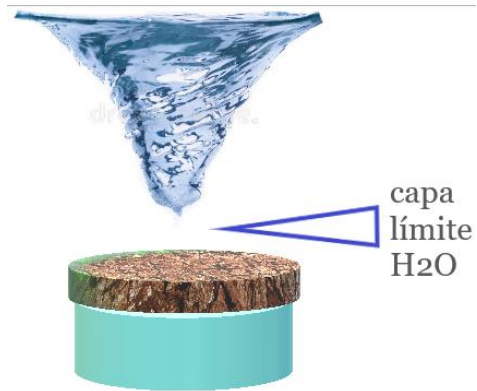
Figura 35. Efecto de la velocidad del disco en el espesor de la capa de agua.
