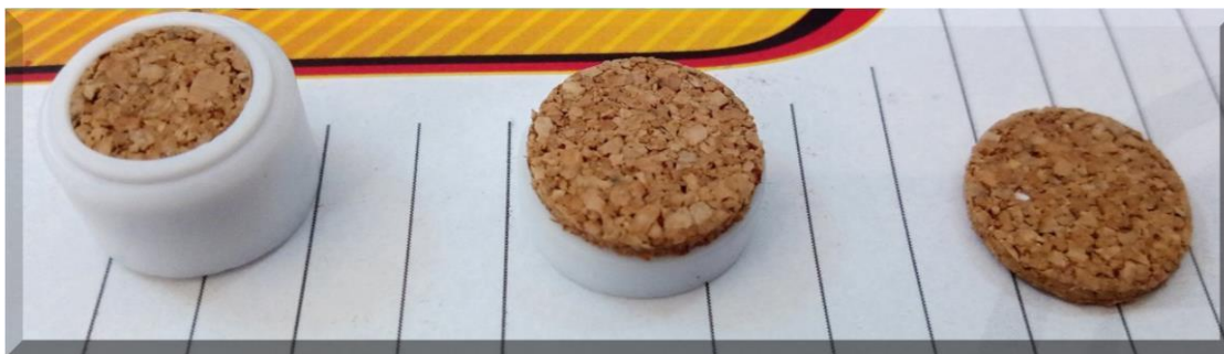
Figura 28. Fase laminar de corcho en disco plano y con cavidad.
