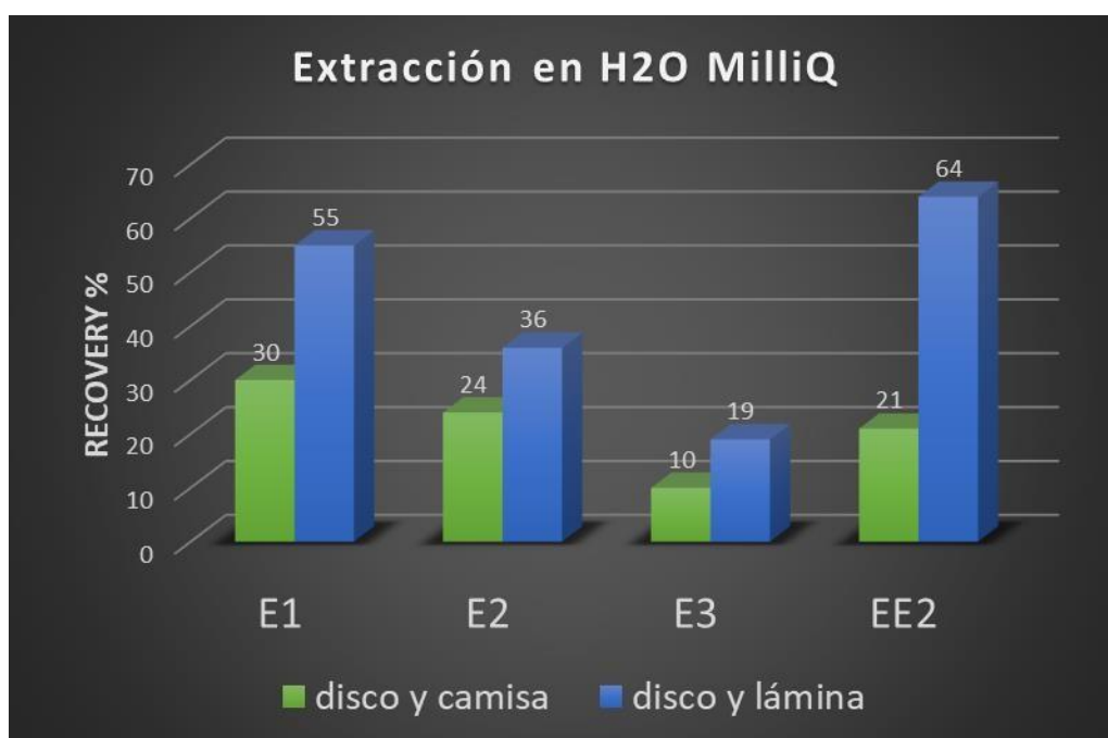
Figura 27. Recuperaciones de analitos en muestras de H 2 O MilliQ con disco plano y disco con camisa.
