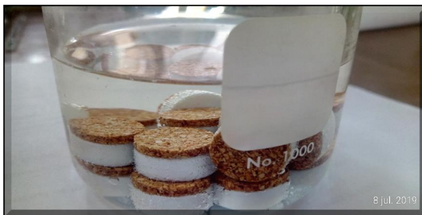
Figura 17. Fase de corcho laminar sometido a limpieza por ultrasonido.
