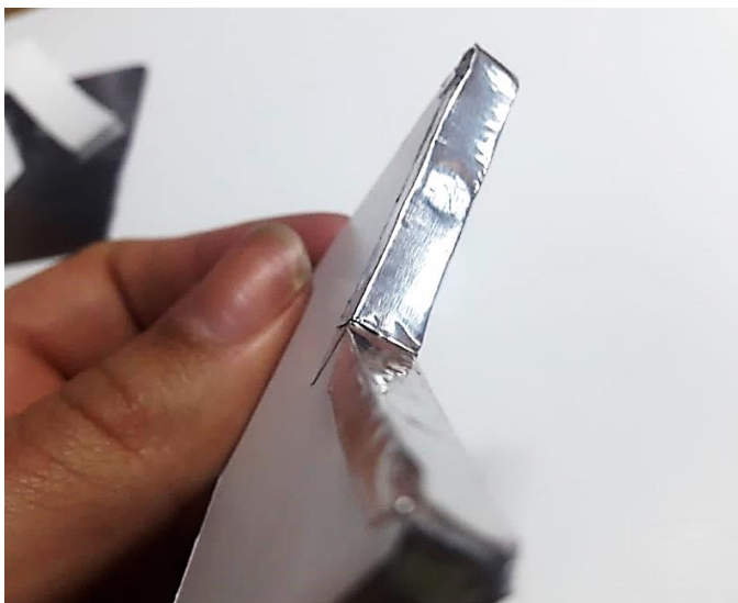
Detalle de pegado de cinta de aluminio en bordes de la pieza.
