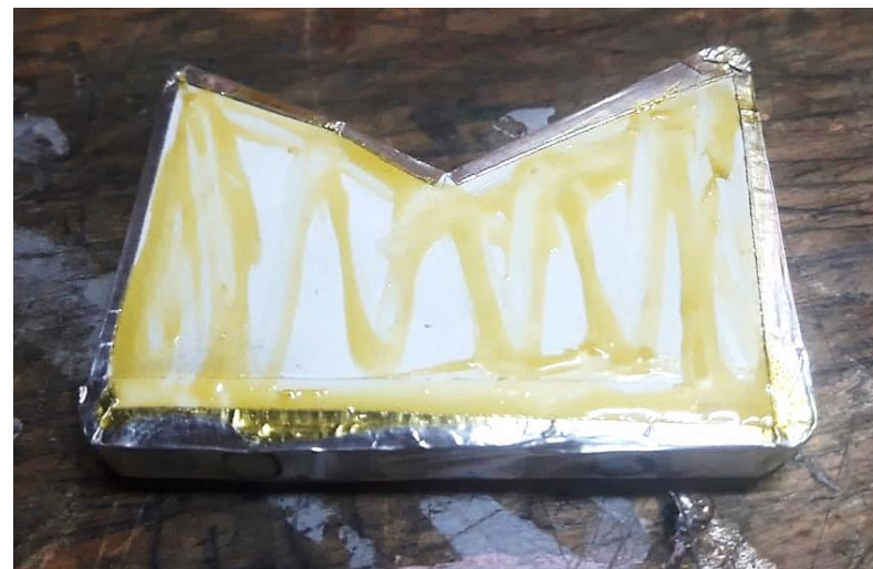
Detalle de aplicación de pegamento de contacto en las caras de la pieza de cartón ya forrada por cinta de aluminio y sus caras de lata.
