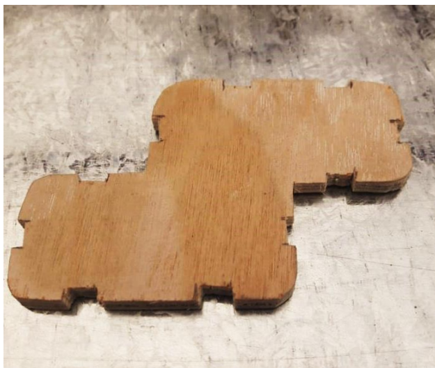
Imagen 53 Pieza de madera con calados para imanes
