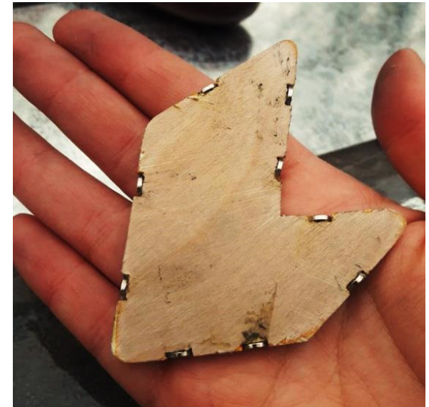
Imagen 52 Pieza de madera con imanes insertos
