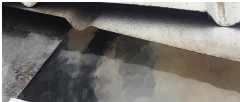
Imagen 49 Lata de 0,35 mm utilizada en prototipos
