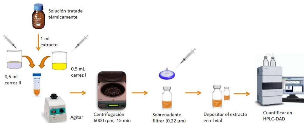
**Figura N°27:** Procedimiento para determinar hidroximetilfurfural (HMF) de cada extracto en HPLC-DAD.
