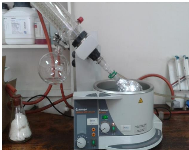
Figura 8.- Montaje de enriquecimiento de biosólido en un rotavapor.
