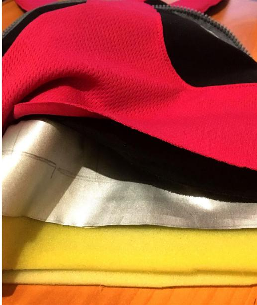
Figura 56: Detalle de capas de tela aluminizada y espuma flexible de poliuretano. Fuente: elaboración propia.
