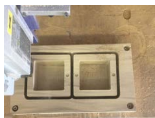
Fabricación router cnc Partes de cubo 3 operaciones Pocket - Desabaste interior Bored - orificio imán Contour - Borde externo
