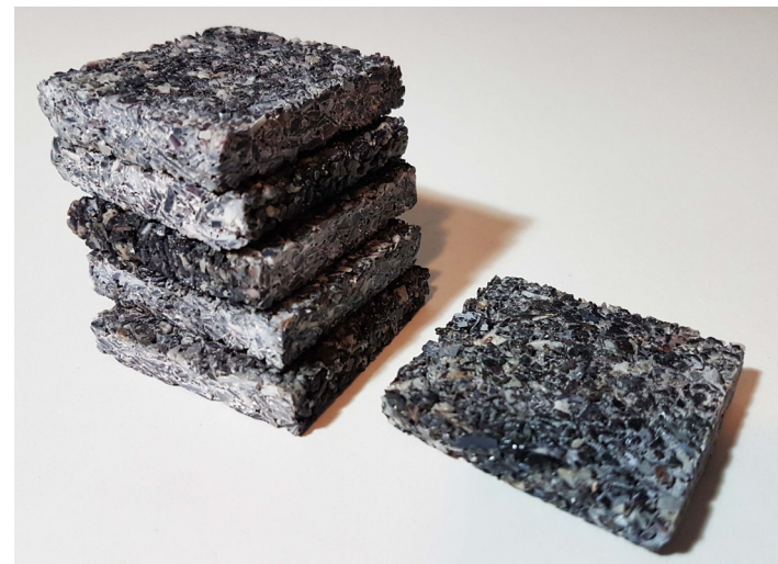
Figura 28: probetas para ensayo de densidad
