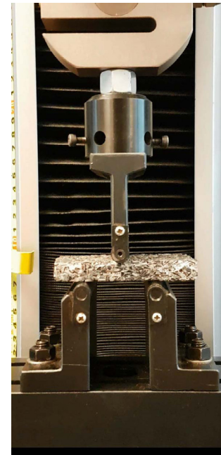
Figura 32: probetas en equipo de ensayo universal modelo WDW-S5
