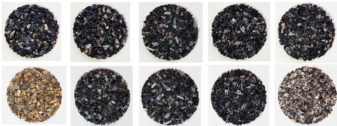
Figura 61: probetas antes y después de ensayo de resistencia a reactivos químicos
