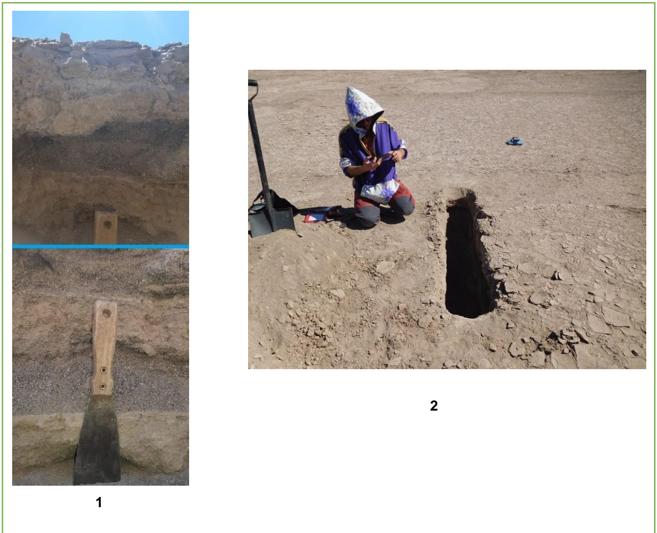
Figura 5: Segundo método de extracción de muestras (Calicata).
