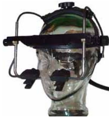
Figure 5. Imagen del dispositivo de seguimiento ocular Eye-Link II que fue utilizado en el estudio.
