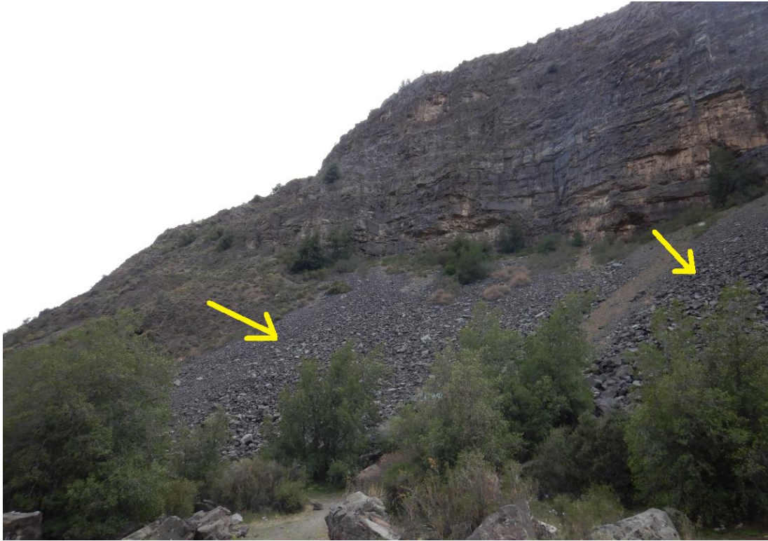
Figura 20: Depósitos de talud en la base de un afloramiento rocoso perteneciente a la Fm. Farellones. Se puede ver la predominancia de granulometría gruesa que presenta el depósito. Este depósito en particular se encuentra aproximadamente en el kilómetro 54.
