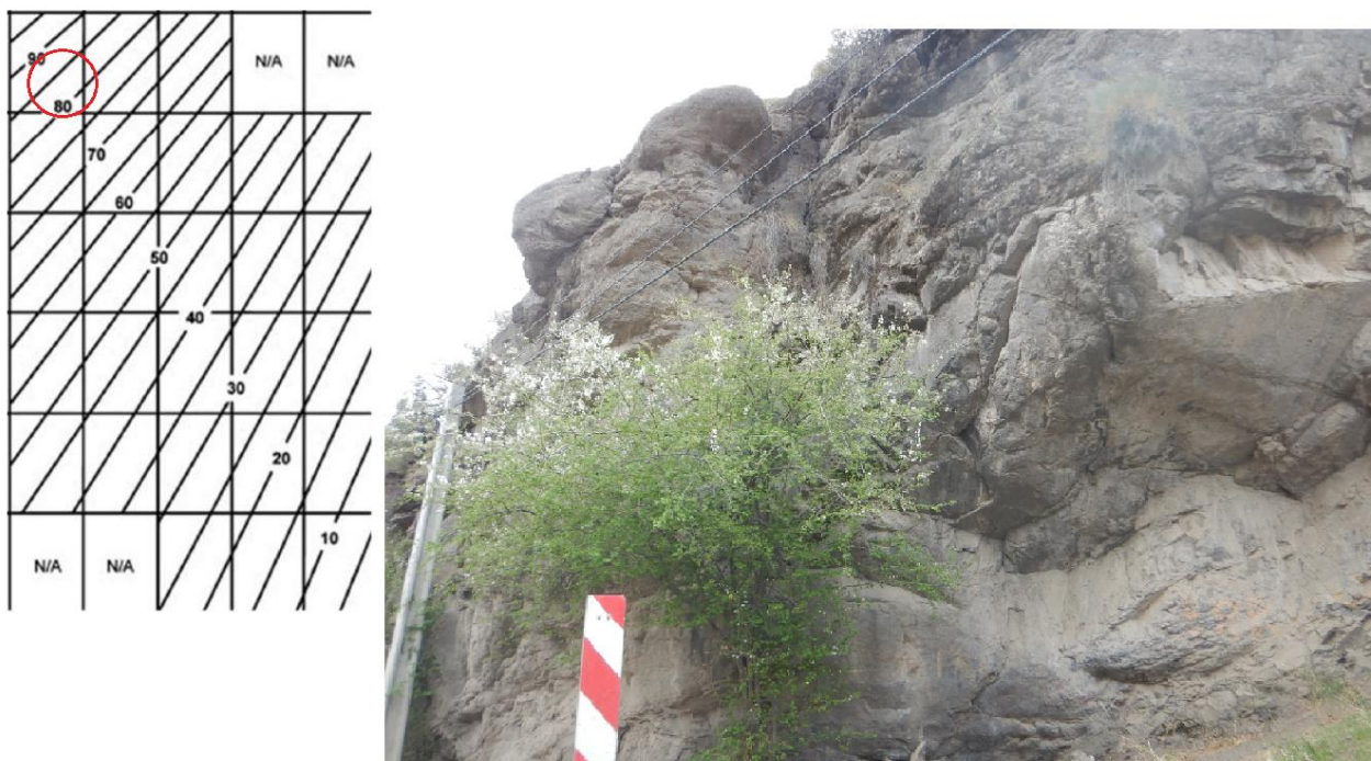
Figura 24: Afloramiento rocoso perteneciente a la Fm. Farellones junto a su respectiva estimación de GSI.
