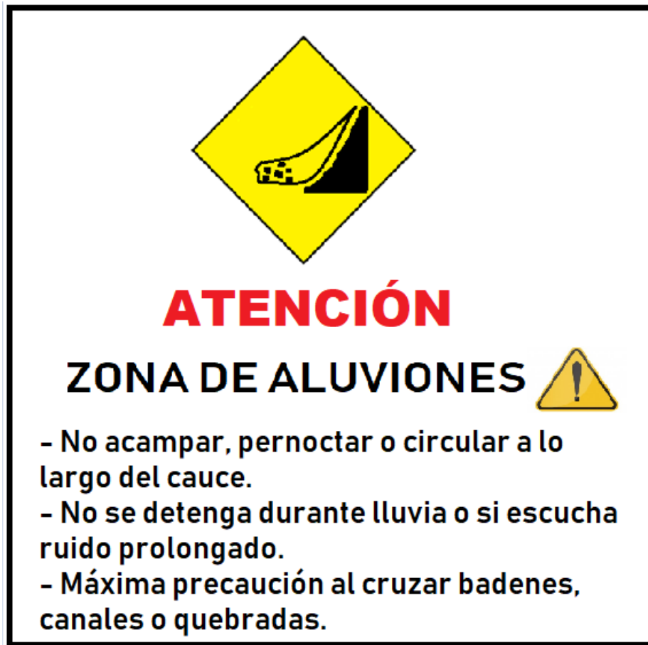
Figura 77: Señalética preventiva para flujos aluviales. Elaboración propia
