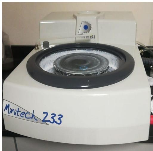
*Figura 13: Máquina pulidora manual utilizada para el pulido y acabado final de las muestras.*
