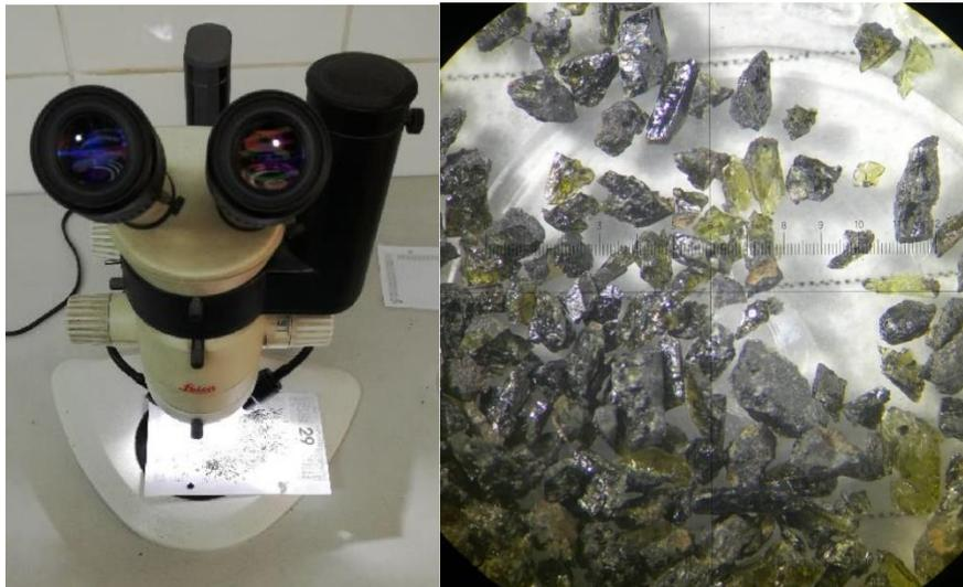
Figura 12: Izquierda: Lupa Binocular. Derecha: Cristales de piroxeno seleccionados.
