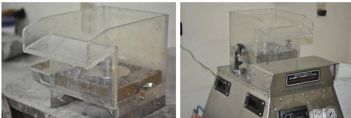
*Ilustración 21: Celda de flotación sola y acoplada a la base. Elaboración Propia.*
