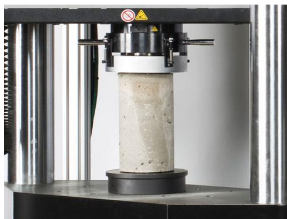
Figura 3.11: Ensayo a compresión probeta cilíndrica de hormigón.
