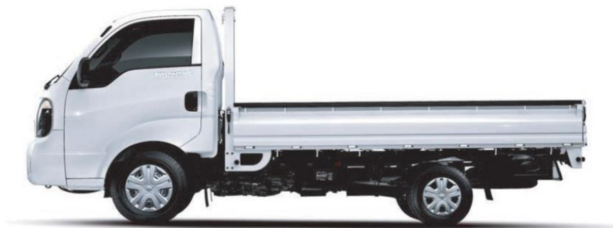
Figura 3.18: Camioneta tipo para diseño de puente
