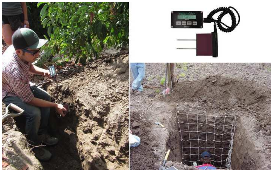
Figura 5. Utilización del equipo TDR en calicata. A la izquierda, inserción del sensor del equipo en el suelo; en la esquina superior derecha equipo TDR 100®, y en la esquina inferior derecha, evaluación de calicata usando una malla cuadrículada de 20 x 20 cm para facilitar y objetivar las evaluaciones.
