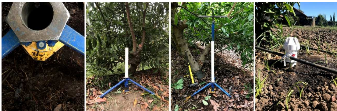
Figura 14. De izquierda a derecha: trípode anclado al suelo y alineado mediante el nivel de burbuja; tubo de acceso introducido en el orificio central del trípode; barreno quitando el suelo dentro del tubo de acceso; tapa superior del tubo una vez completamente instalado. Huerto adulto de paltos 'Hass'.
