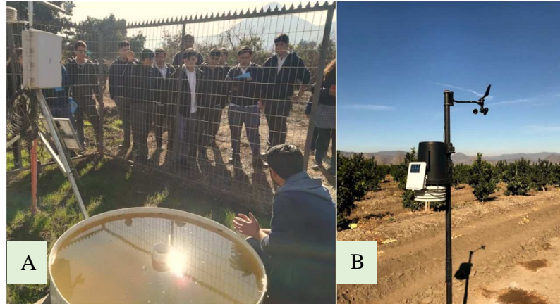
Figura 1. Instrumentos para estimar la ET_0 (mm/día) por diferentes métodos. (A) bandeja de evaporación tipo “A”, y (B) estación meteorológica.
