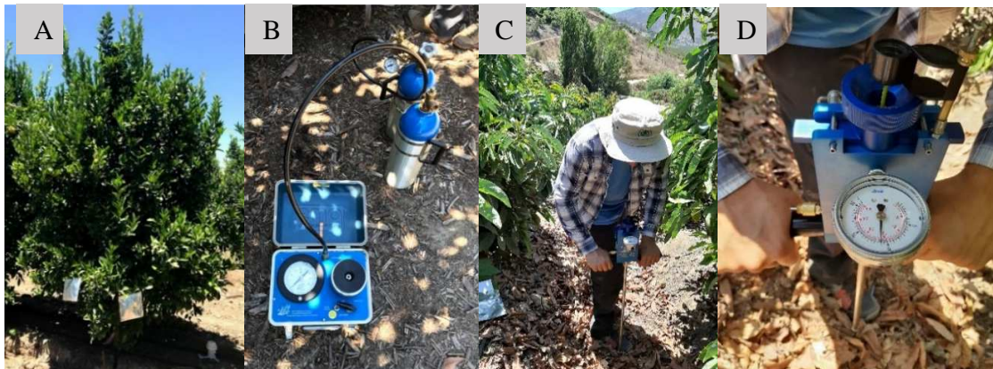
Figura 4. (A) Hojas de mandarina cubiertas con bolsa de aluminio para la medición de potencial xilemático a mediodía. (B) Cámara de presión tipo Scholander tradicional (Modelo 600) y (C y D) modelo Pump-up (PMS Instrument Company, Oregon, EE.UU.).
