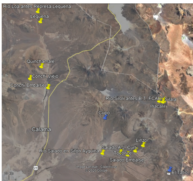
Figura A.4: Estaciones metereológicas ubicadas al noreste de El Loa. En amarillo se muestran las estaciones cercas de un río principal, mientras que en azul las que tienen un caudal superior a 80 mm/año.
