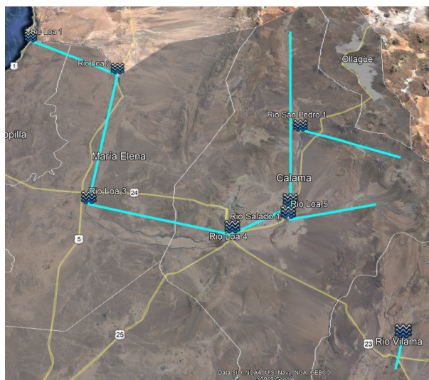
Figura I.5: Simplificación de las rutas de los principales ríos de Antofagasta, donde los puntos marcados corresponden a los nodos que representan los puntos de extracción o inyección a los ríos, y abarcan las secciones marcadas con líneas celestes. Figura hecha en Google Earth ® .
