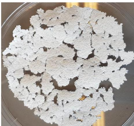
Figura 16: Celulosa prensada para realizar las caracterizaciones por FTIR, DRX y TGA.
