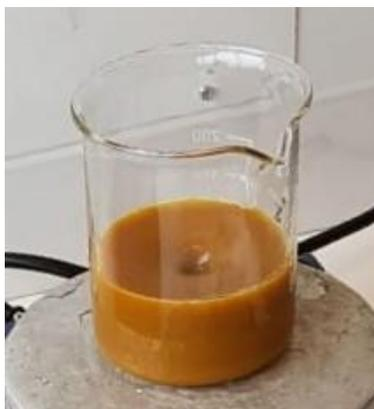
Figura 15: Mezcla de Cloruro férrico hexahidratado y acetato de sodio en glicol etileno
