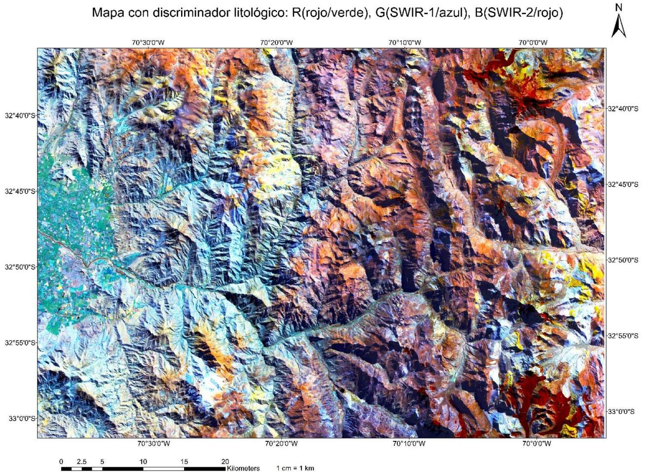
Figura 60: Imagen satelital generada en ENVI 5.3 a partir de una combinación de bandas Landsat 8 OLI. La combinación RGB está conformada por R: Rojo/Verde; G: SWIR-1/Azul; B: SWIR-2/Rojo.
