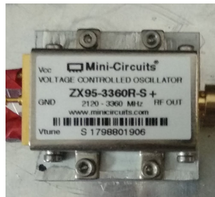
Figura 4.2: VCO modelo ZX95-3360R-S+ desarrollado por minicircuits
