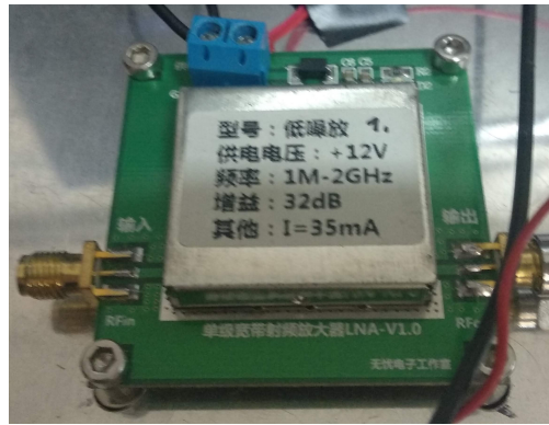
Figura 4.6: Amplificador Genérico de 32 dB
