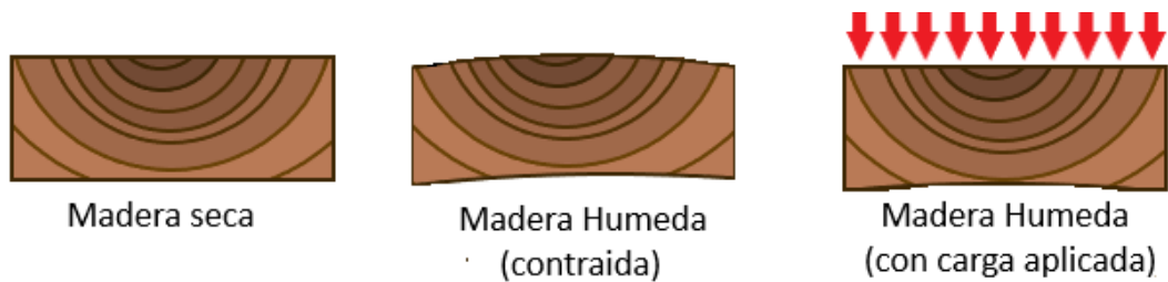
Ilustración 58, correcta disposición de un madero ante carga distribuida. Elaboración propia.
