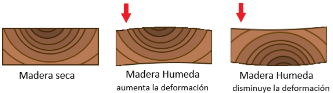
Ilustración 59, opciones de cómo orientar un madero ante cargas puntuales en un extremo. Elaboración propia.
