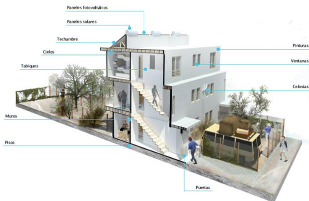
Isométrica de una vivienda de 3 pisos. Fuente: <http://madera.uc.cl/documentos/69-manual-del-usuario/file>
