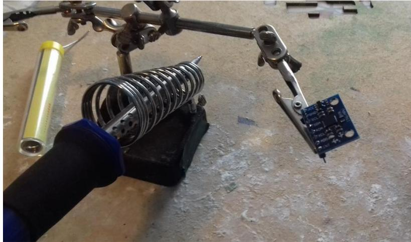
**Fig. N°111:** Soldando los pines para el giroscopio/acelerómetro.
