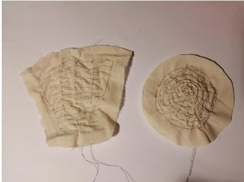
**Fig. N°143:** Nuevos diseños del sensor táctil capacitivo. El de la izquierda va ubicado en la frente, mientras que el de la derecha va en la nariz del peluche.
