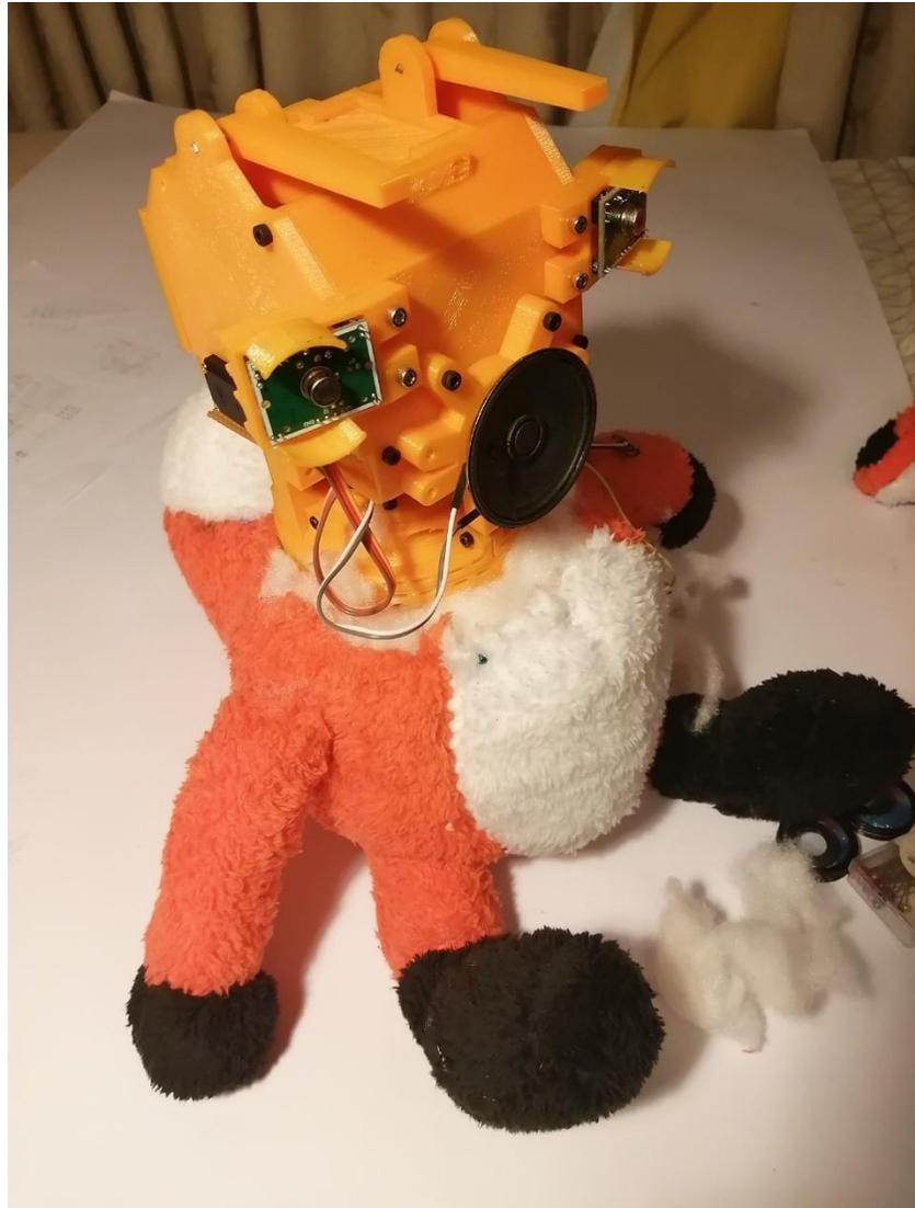
**Fig. N°142:** Cráneo del peluche expuesto. Se observa la pieza que sostiene los sensores de movimiento y los ojos para darle forma al rostro. También se aprecia el parlante y la estructura que lo sostiene.
