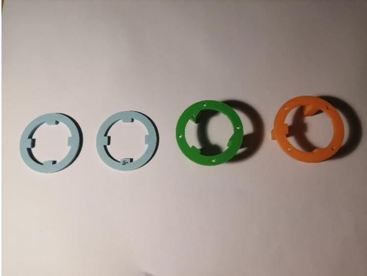
Una vez diseñado el sistema del cuello, se modela el riel que soportara las cargas de la estructura. El riel al tener que recibir los esfuerzos que experimenta la cabeza, tiene que ser resistente, pero al mismo tiempo, ser lo suficientemente liso y con un mínimo contacto con las mordazas para reducir la fuerza de fricción.
