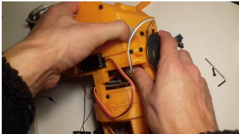
**Fig. N°120:** Instalación del parlante en el cráneo del peluche.
