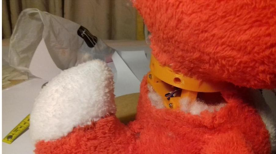
**Fig. N°129:** Cuello del peluche luego de instalar el sistema de bisagras en las piernas y en la cola. Se aprecia que la tela no es capaz de llegar hasta el sistema de cosido tangencial en el cuello.
