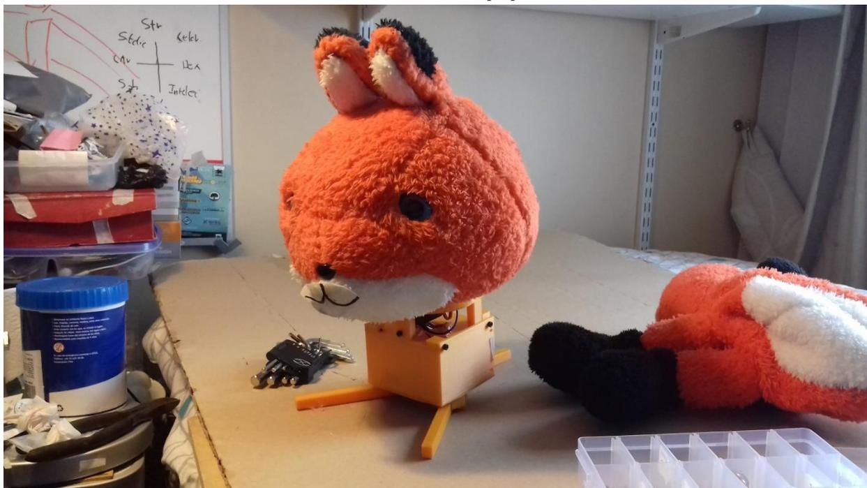
**Fig. N°128:** Sistema de las piernas montado en el esqueleto completo, incluyendo la cabeza completamente funcional.
