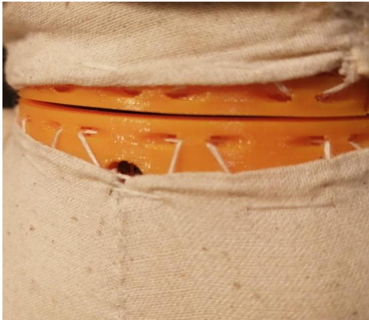
**Fig. N°97:** Hilos que unen la tela del peluche la estructura del cuello
