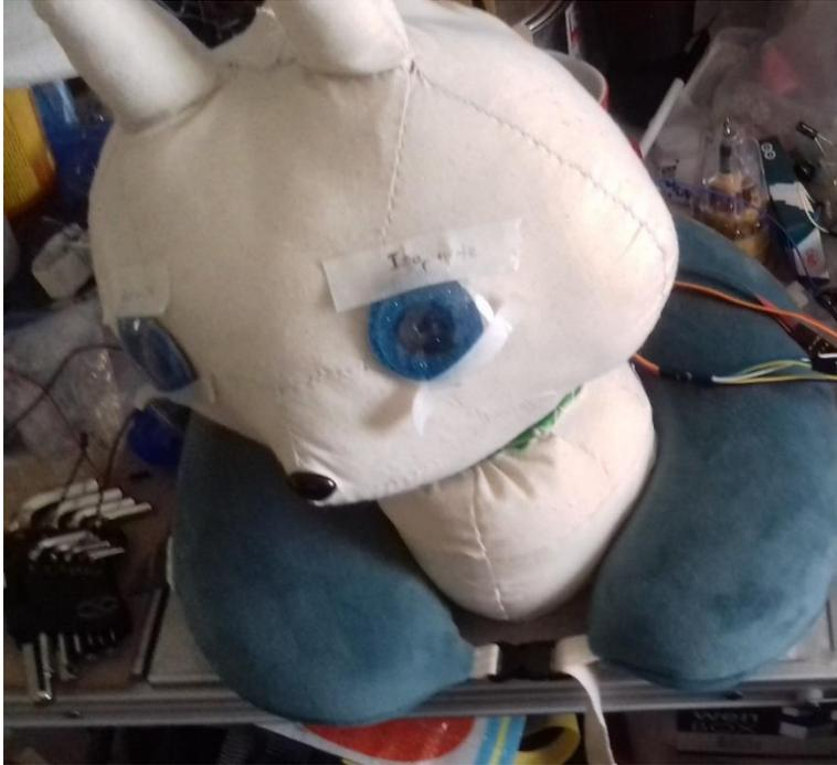
**Fig. N°91:** Prototipo del peluche robótico, el cual cuenta con el mecanismo de las orejas, el cuello, los sensores de movimiento y los sensores táctiles completamente operativos.
