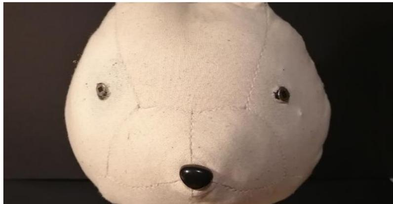
**Fig. N°82:** Cara del peluche, al que se le añadieron los sensores de movimiento en los ojos y una nariz de peluche
