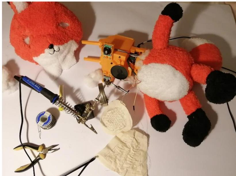
**Fig. N°144:** integración de los sensores táctiles capacitivos en la electrónica del peluche. Estas piezas fueron soldadas a cables jumper para ser unidas fácilmente a la PCB del prototipo.
