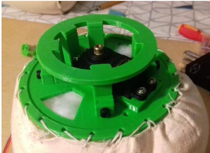
**Fig. N°76:** Rieles unidos a la base del cuello. EL servomotor utilizado es el MG955
