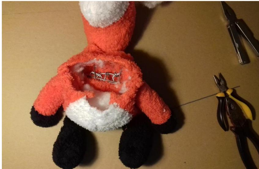
**Fig. N°126:** Prototipo en alambre para las piernas siendo probado dentro del peluche. En la imagen se puede ver como la estructura esta inserta dentro del cuerpo, teniendo las guías dentro de las piernas.
