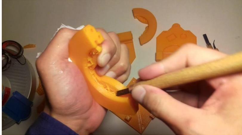
**Fig. N°108:** Limpieza de las piezas impresas en 3D. Se les quitan los soportes y la plataforma de adhesión.
