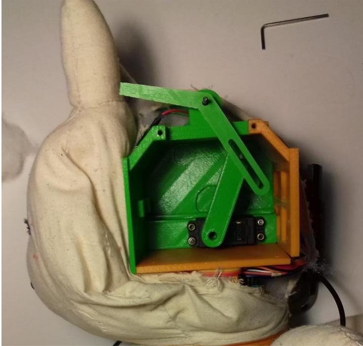
**Fig. N°89:** Cráneo abierto del peluche robótico. Se aprecia el mecanismo que permite mover las orejas.
