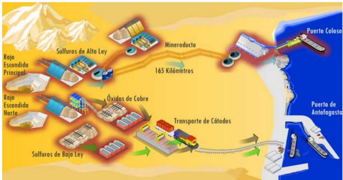
Figura 4: Macro Proceso de Producción de Cobre en Minera Escondida. Fuente: Obtenido de [15].
