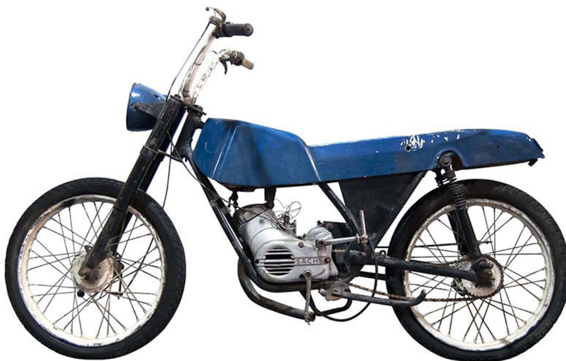
Figura 1. Fotografía de la Motochi50 de color azul. Una de las primeras en ser producidas, solo hubo cinco o diez de este color, el resto rojas y blancas. El foco redondo, la carcasa y el estanque estaban confeccionados en fibra de vidrio. Fuente: Archivo personal de los autores.
