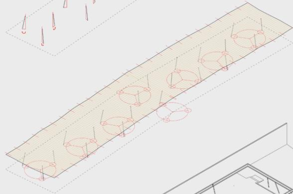
Se diseña una estructura metálica que comprende vigas y postes con el fin de consolidar el borde de la lámina y tensarla; y posteriormente generar un perímetro de cerramiento.
