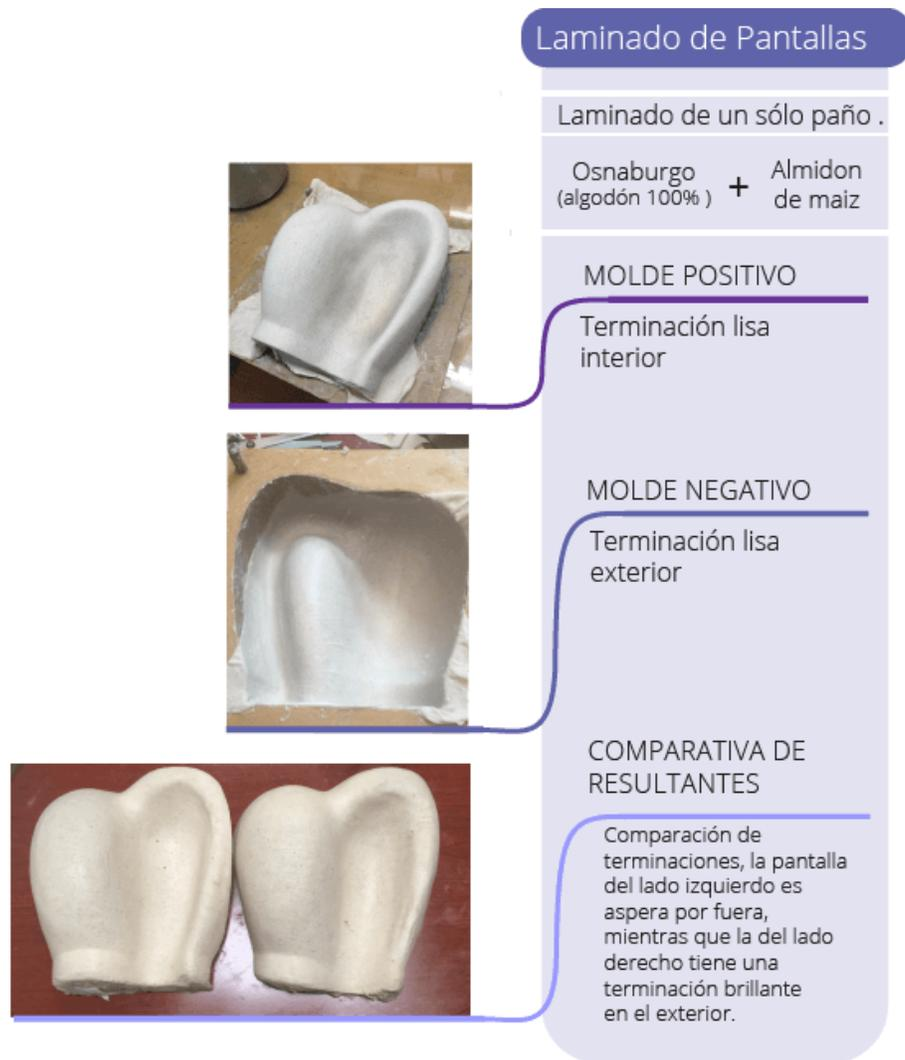
**Figura 71:** Diagrama de laminado de pantallas. Elaboración propia.
