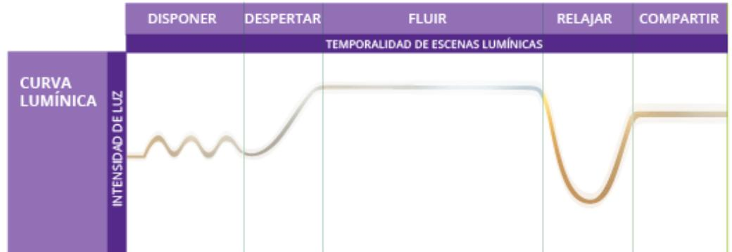
En la figura 65, se puede observar la curva lumínica propuesta para acompañar la práctica de yoga respecto a dos ejes, el eje x representa la oscilación de la intensidad de la luz (medida en Lux), el eje y representa la duración de cada escena lumínica y el color de la curva, la temperatura de la iluminación asociada (medida en k).
