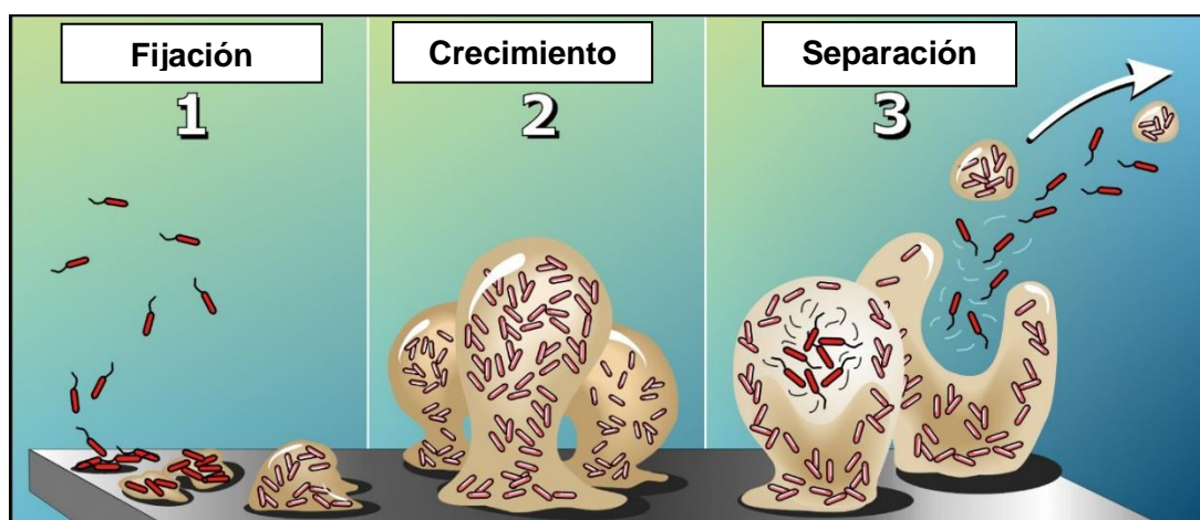
Figura 7: Esquema de la formación de biopelícula en membranas de osmosis reversa. Adaptado de [30].
