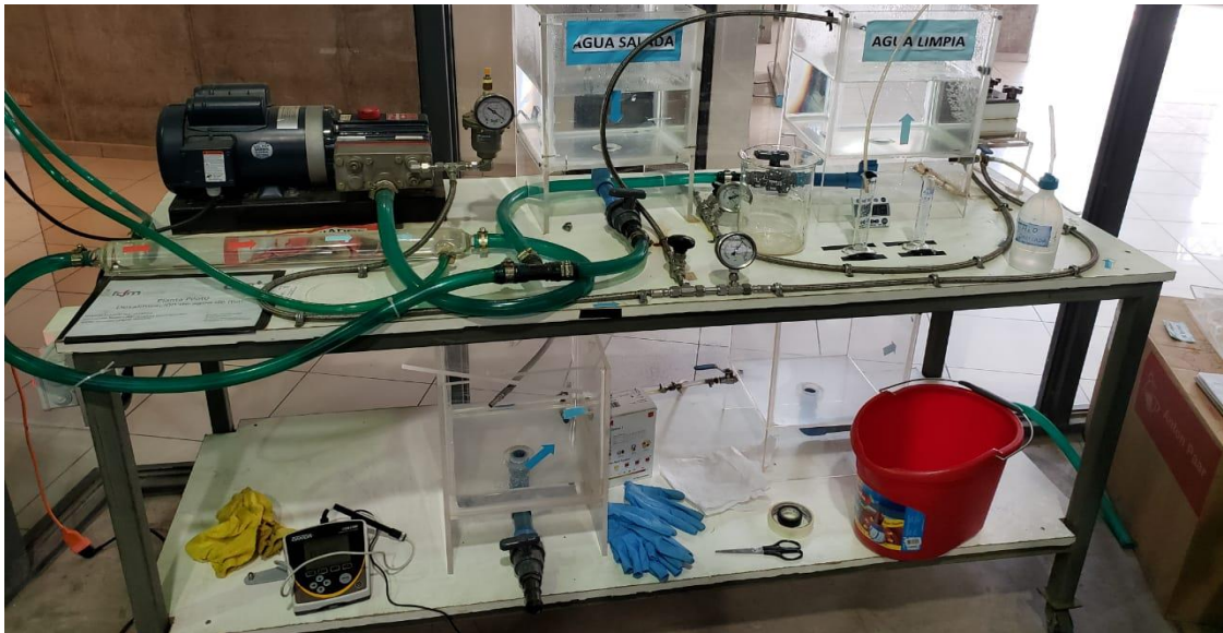
Figura 14: Fotografía de la planta piloto utilizada para pruebas de osmosis reversa.
