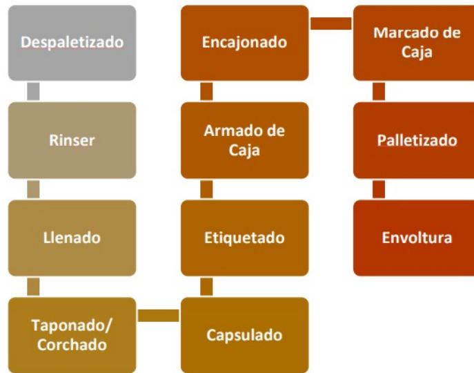
Figura 1.18: Flujo de proceso embotellado Viña Santa Rita
