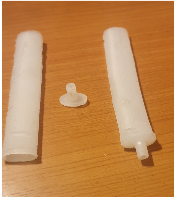
Figura 5.10: De izquierda a derecha: Cilindro elíptico, pared con boquilla y actuador neumático ensamblado
