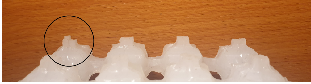
Figura 4.6: Ejemplo de un borde sobresaliente en la estructura 2
