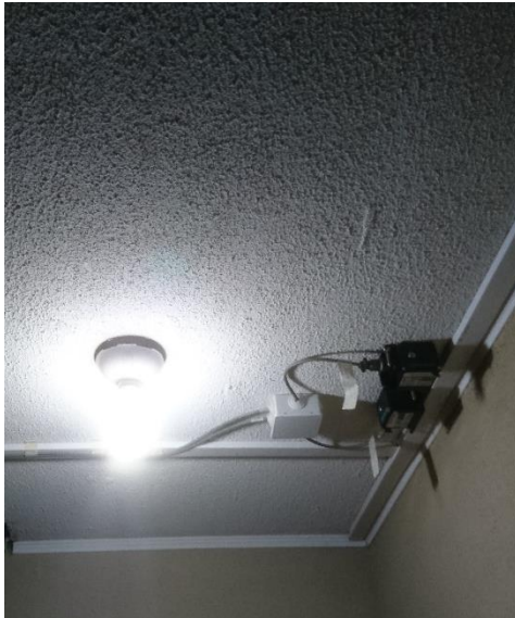
Figura 3.35: Fotografías de EpiSensor ubicados en la zona húmeda del Piso 15, a la izquierda se encuentra uno en dirección N-S, a la derecha se encuentran en dirección N-S y E-O.
