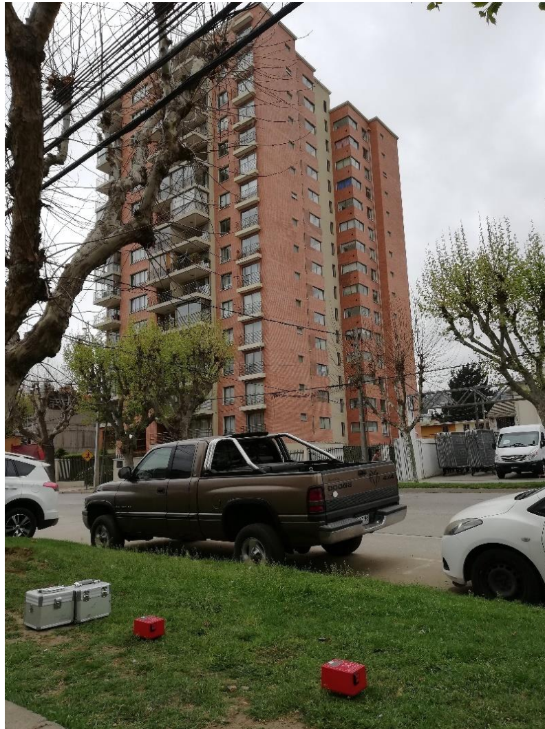
Figura 4.8: Medición de suelo con sismómetros TROMINO.
