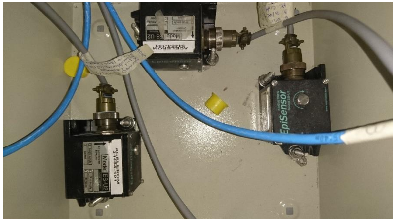
Figura 3.32: Fotografía de EpiSensor ubicados en subterráneo -2 en la fundación del edificio, considerados como campo libre del edificio, todos con diferente orientación N-S, E-O y uno vertical.
