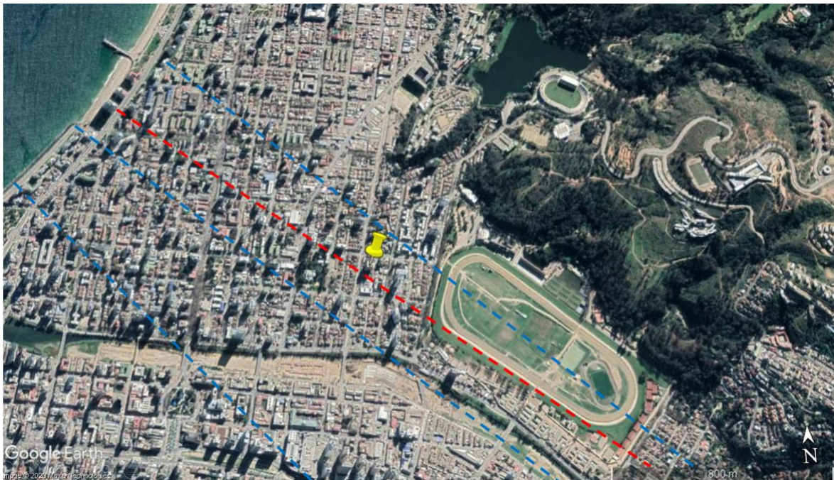
Figura 3.13: Ubicación de traza de la falla Marga-Marga en línea punteada roja, y lineamientos paralelos en color azul, que corresponderían a los límites de una zona de falla según Muñoz et al.(2015).
