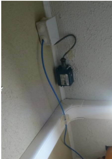
Figura 3.33: Fotografías de EpiSensor ubicados en la zona húmeda del Piso 1, a la izquierda se encuentra uno en dirección N-S, a la derecha se encuentran en dirección N-S y E-O.
