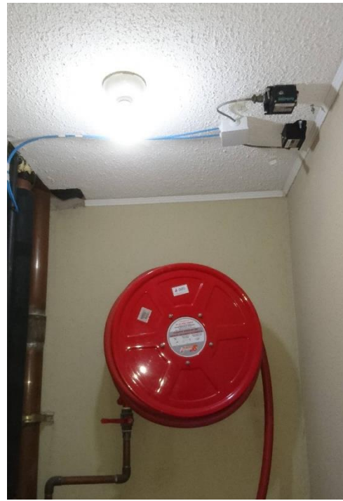
Figura 3.34: Fotografías de EpiSensor ubicados en la zona húmeda del Piso 8, a la izquierda se encuentra uno en dirección N-S, a la derecha se encuentran en dirección N-S y E-O.
