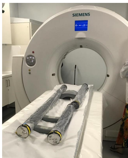
Figura 2.5. Fotografía del equipo de tomografía computarizada SOMATON Definition Edge del Centro de Imagenología del Hospital Clínico “J.J. Aguirre” de la Universidad de Chile.
