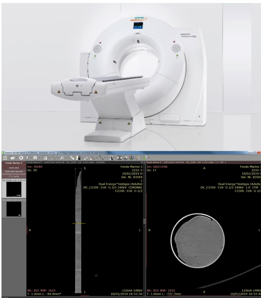
Figura 2.6. A) Equipo SOMATON Definition Edge de tomografía computarizada de rayos X del Centro de Imagenología del Hospital Clínico de la Universidad de Chile. B) Imagen del software RadiAnt DICOM Viewer mostrando las secciones transversales y longitudinales de un testigo de sedimento.
