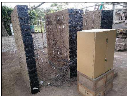
Figura 3.44: Muros Adobe, lugar y equipo de monitoreo (Milton 2017).
