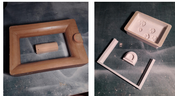
figura 69: Imágenes del proceso de fabricación del master fuente: Elaboración propia
