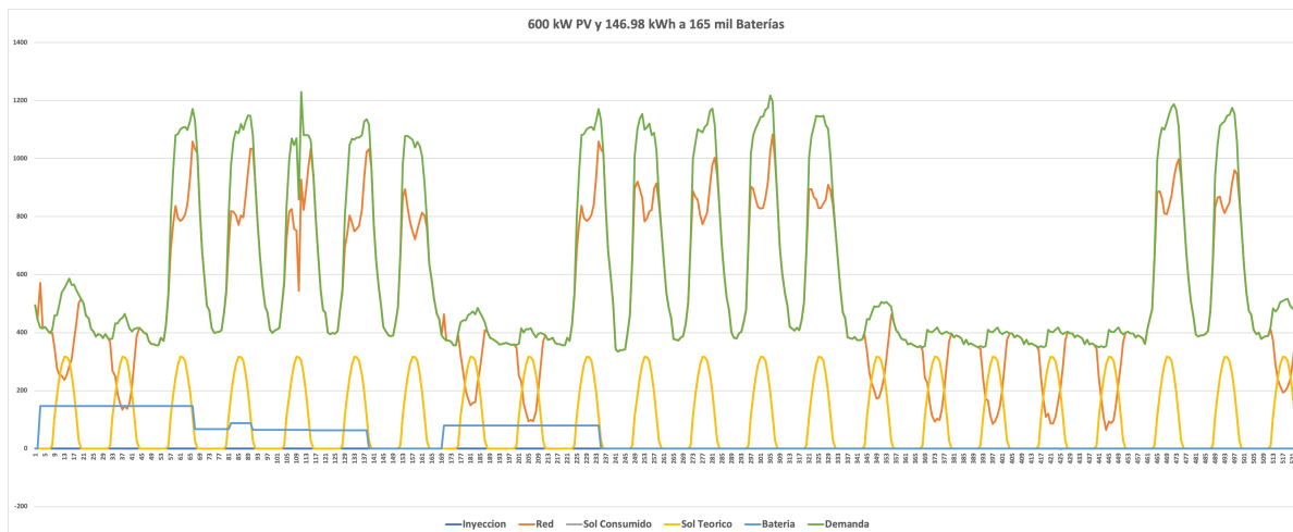
Figura 5.17: Curva de consumo energético horario de 3 semanas del cliente edificio laboral Enel a partir del sábado 1 de septiembre al lunes 3 de septiembre de 2018. El cliente invierte en 0,6 MW FV y 147 kWh de baterías.
