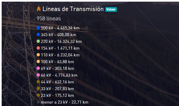
Figura 2.23: Número de kilómetros de líneas de transmisión de acuerdo a su tensión.
