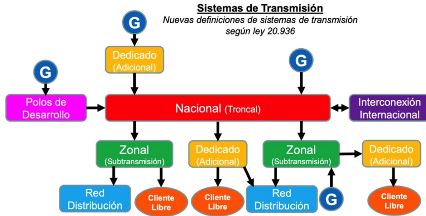
Figura 2.24: Transmisión eléctrica en Chile a día de hoy. Fuente: Mercado Eléctrico Chileno 2018, Universidad de Chile.
