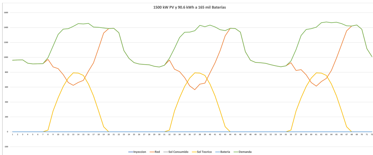
Figura 5.7: Curva de consumo energético horario de 3 días del cliente comercial Enel a partir del sábado 1 de septiembre al lunes 3 de septiembre de 2018. El cliente invierte en 1,5 MW FV y 91 kWh de baterías.
