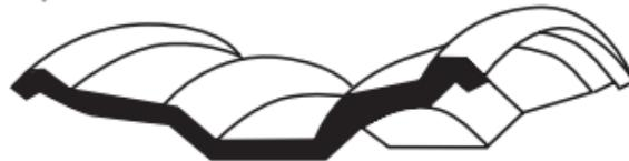
Figura 14: Aro (llanta, rin) con asentamiento a  $15^\circ$ .
