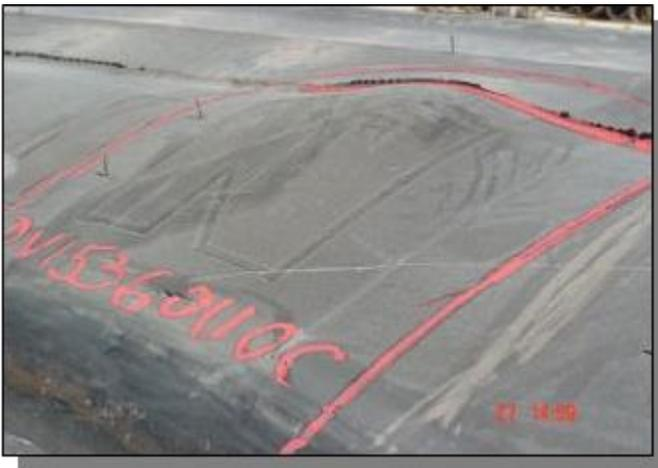
**Descripción:** Burbujas en la banda lateral (Flanco). Separación entre componentes internos del neumático.
