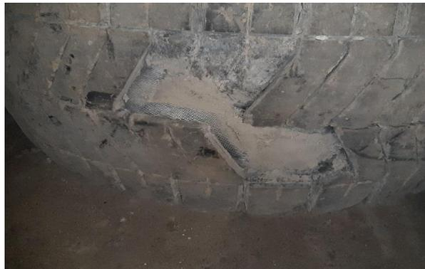
*Figura 19: Separación por calor.*
