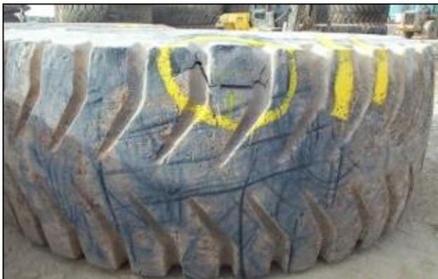
*Figura 17: Corte de neumático en banda de rodado.*
