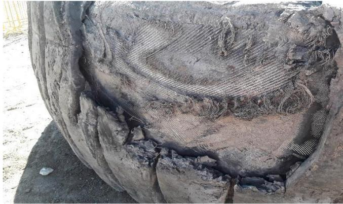
*Figura 18: Separación por corte.*
