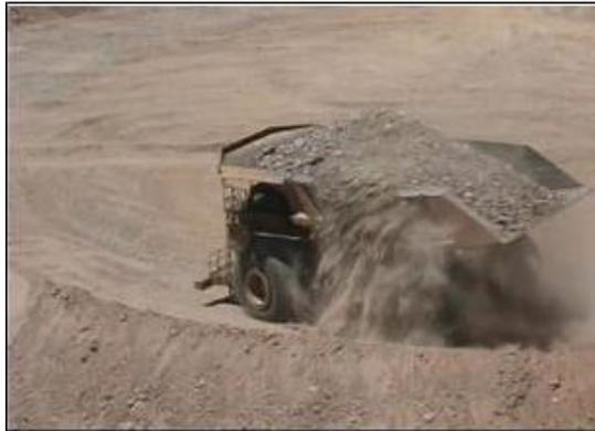
*Figura 49: Camión al no respetar la velocidad en las curvas.*
