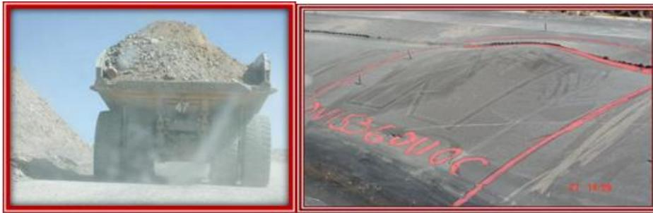
Figura 20: Motivo de separación mecánica (carga descentrada), consecuencias que genera (burbujas banda lateral).
