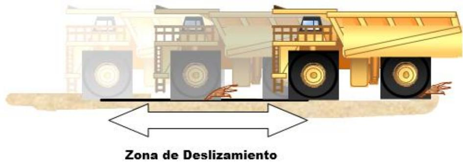
Figura 46: Efecto de un frenado brusco de los camiones.
