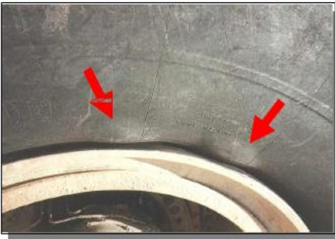
**Descripción:** Burbujas en la zona baja de la banda lateral. Separación entre gomas internas del neumático.
