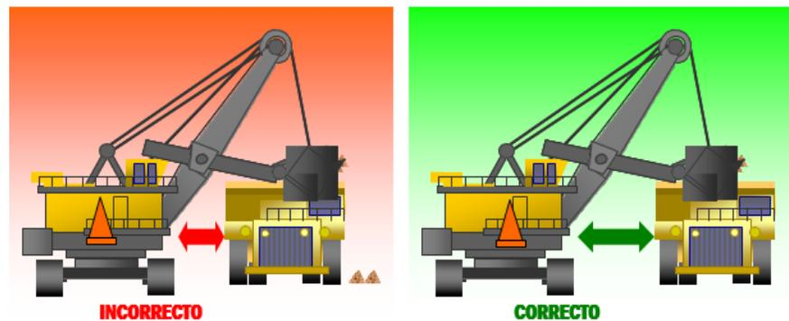
Figura 51: Demostración de ubicación del camión al ser cargado.
