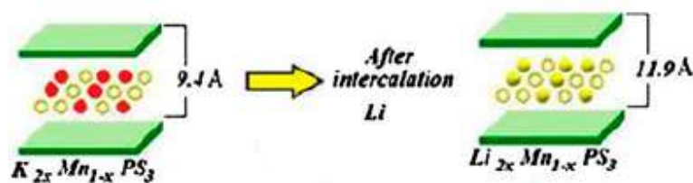
Figura 21: Esquema de intercalación de iones \text{Li}^+ en la fase de \text{MnPS}_3 . Los círculos vacíos amarillos, existentes en ambas fases, corresponden a los huecos disponibles para la movilidad de los iones, los círculos rojos rellenos son los iones potasio y los círculos rellenos amarillos a los iones \text{Li}^+ .
