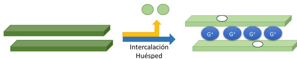
Figura 3: Esquema básico de intercalación de especies catiónicas monovalentes en fases laminares MPS_3 . Las esferas verdes son cationes divalentes del metal M^{II} de la lámina, las esferas blancas son vacancias, y las esferas azules corresponde a la especie química intercalada, cationes monovalentes.
