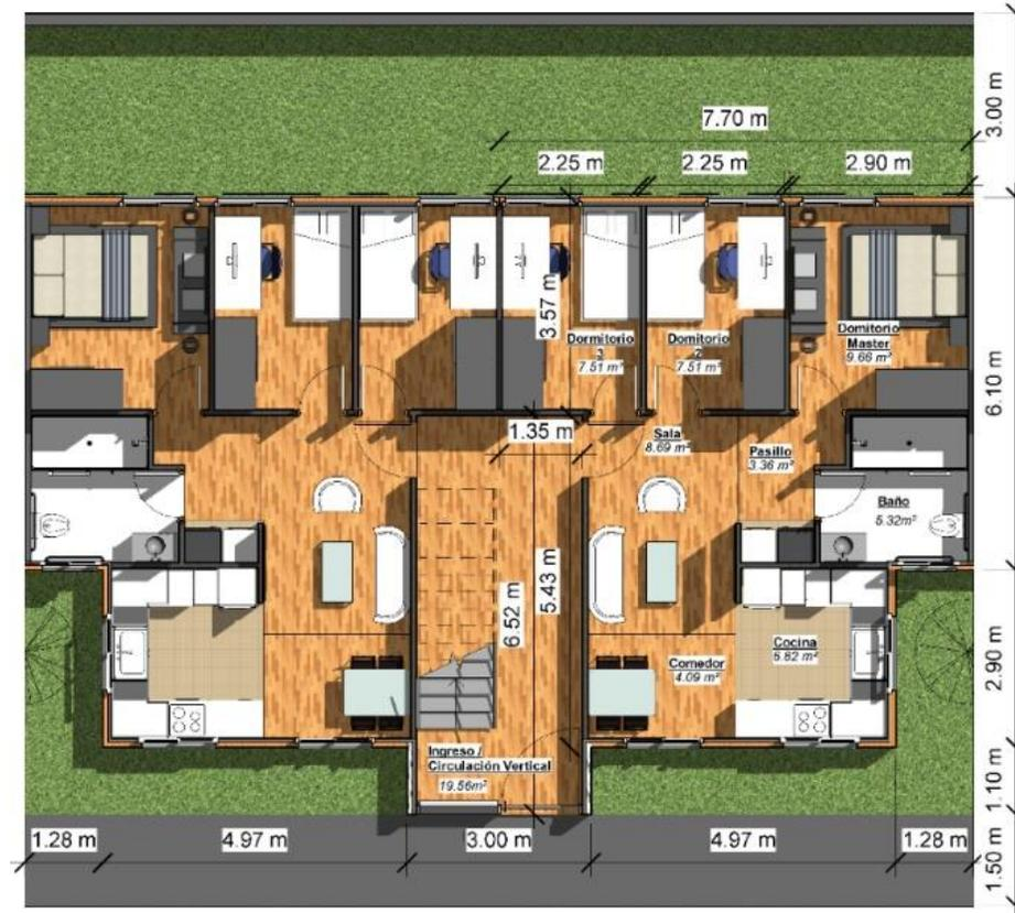
Ilustración 9 - Planta tipo de departamentos de 58.03m<sup>2</sup> en planta baja.
