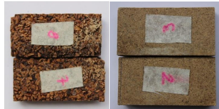
Figura 58. Probetas expuestas al ataque de termitas, vista frontal. Elaboración propia.
