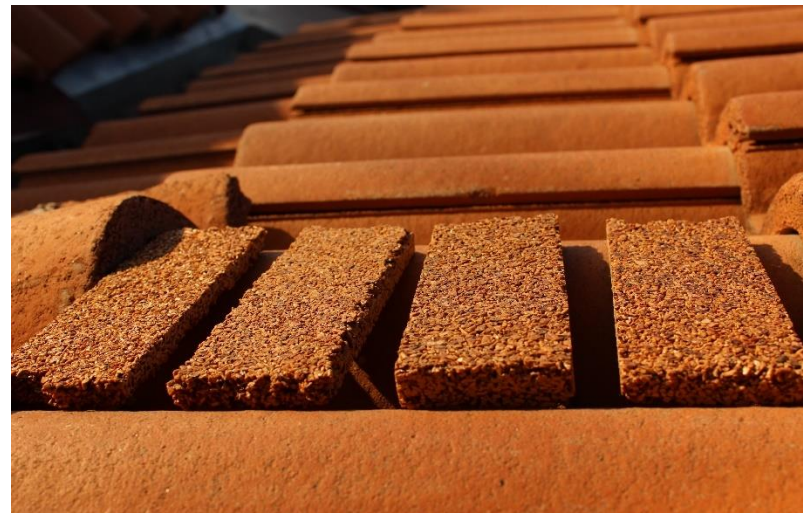
Figura 34. Muestras expuestas a rayos UV. Elaboración propia.
