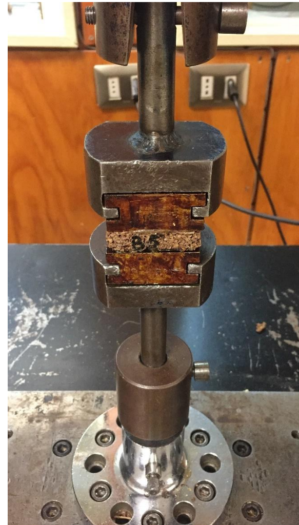
Figura 31. Ensayo de tracción en ejecución. Elaboración propia.
