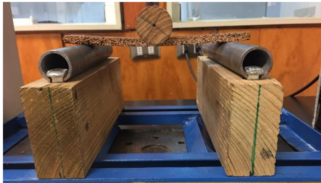
Figura 32..Ensayo de flexión en ejecución. Elaboración propia.
