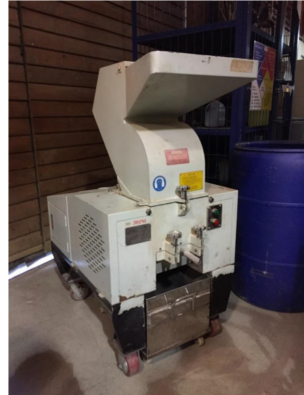
Figura 21: Molino de multicuchillas Ming Lee. Elaboración propia.
