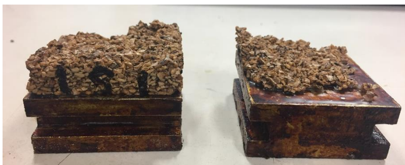
Figura 53. Desprendimiento de una de las caras en ensayo de tracción perpendicular. Elaboración propia.
