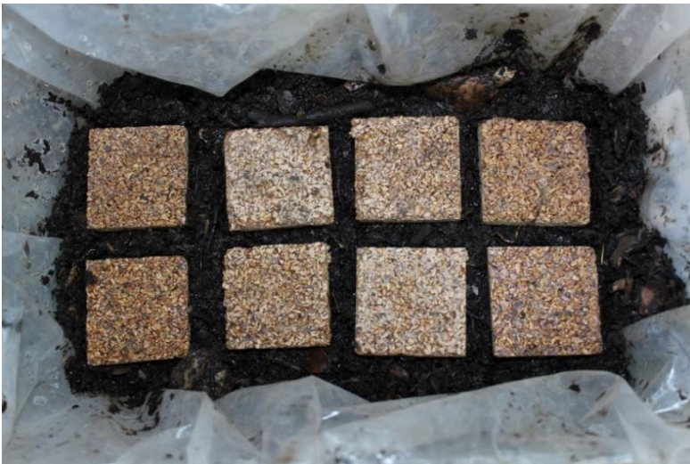
Figura 35. Probetas en ensayo de envejecimiento. Elaboración propia.
