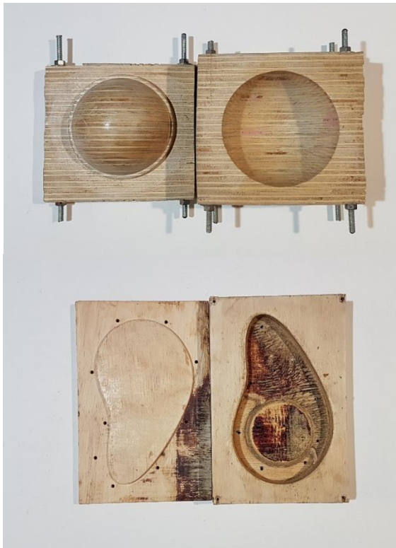
Figura 38. Moldes de terciado. Elaboración propia.
