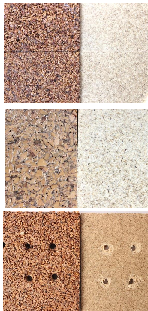
Figura 62. Mecanizado de corte, lijado y perforado respectivamente. Elaboración propia.
