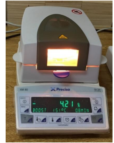
Figura 23. Termobalanza Precisa. (Elaboración propia).
