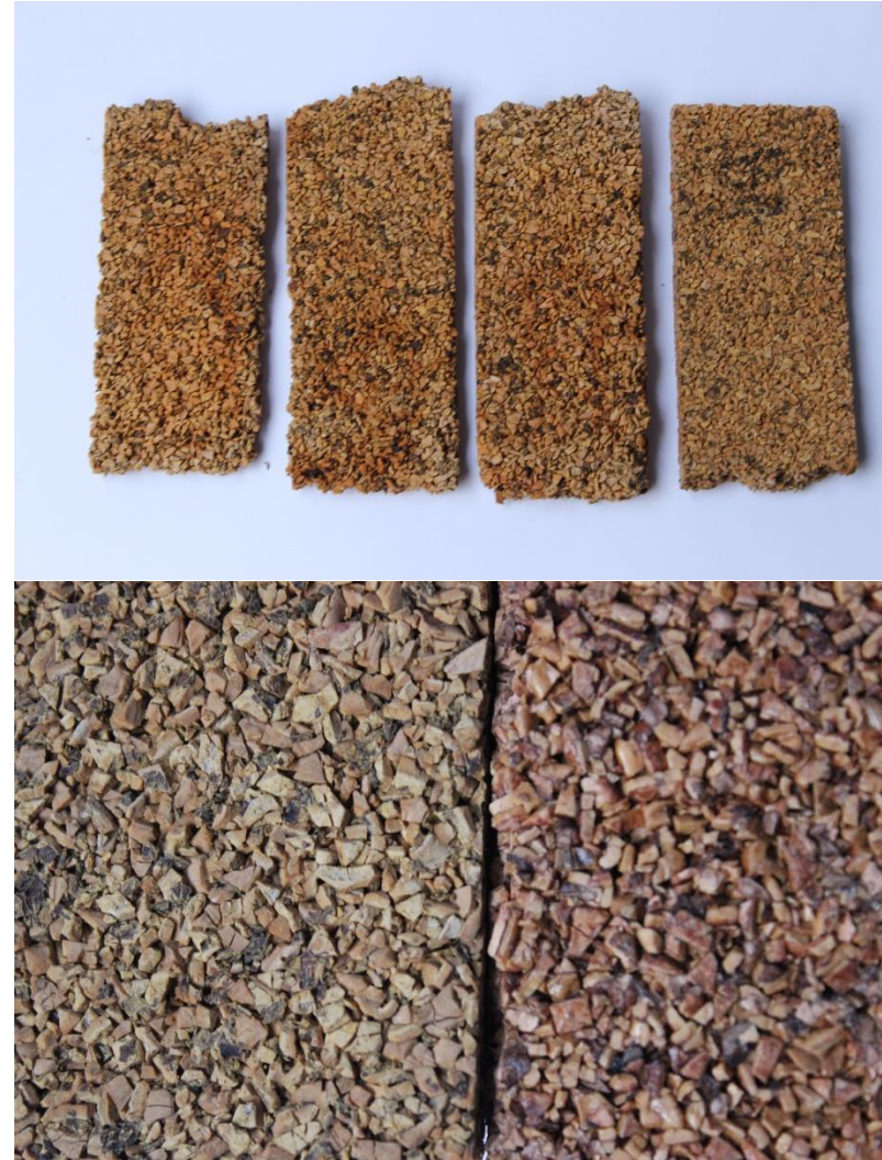
Figura 61. Muestras expuestas a rayos UV. Elaboración propia
