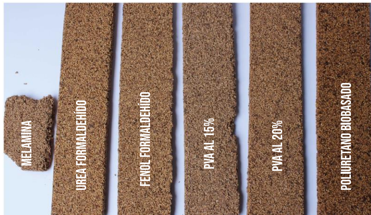
Figura 45. Resultados de la experimentación con adhesivos disponibles. Elaboración propia.
