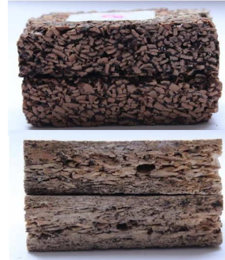
Figura 57. Probetas expuestas al ataque de termitas, vista lateral. Elaboración propia.
