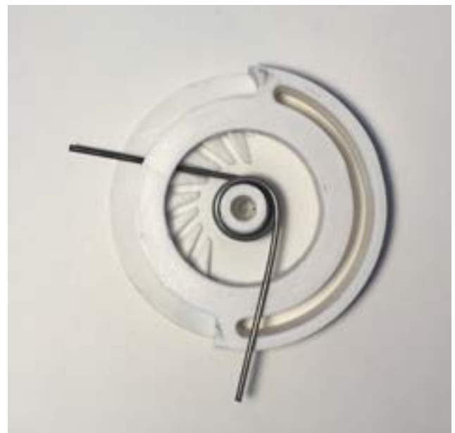
Fig 78. Prueba de base dentada para graduación de fuerzas, elaboración propia.
