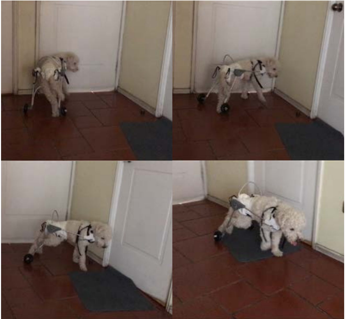
Fig 76. Prueba de giro con rueda de 80 mm y rodamiento , elaboración propia.
