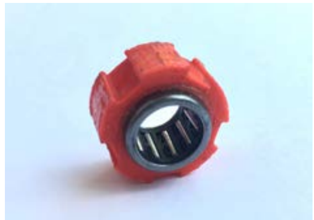
Fig 75. Rodamiento anti reversa con adaptador para rueda en impresión 3D , elaboración propia.
