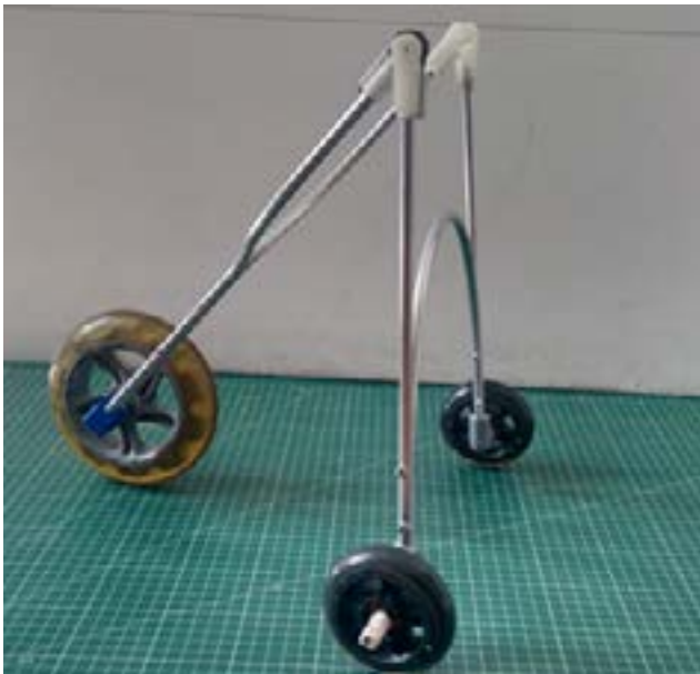
Fig 67. Marco ensamblado con mecanismo de resorte y ruedas, elaboración propia.
