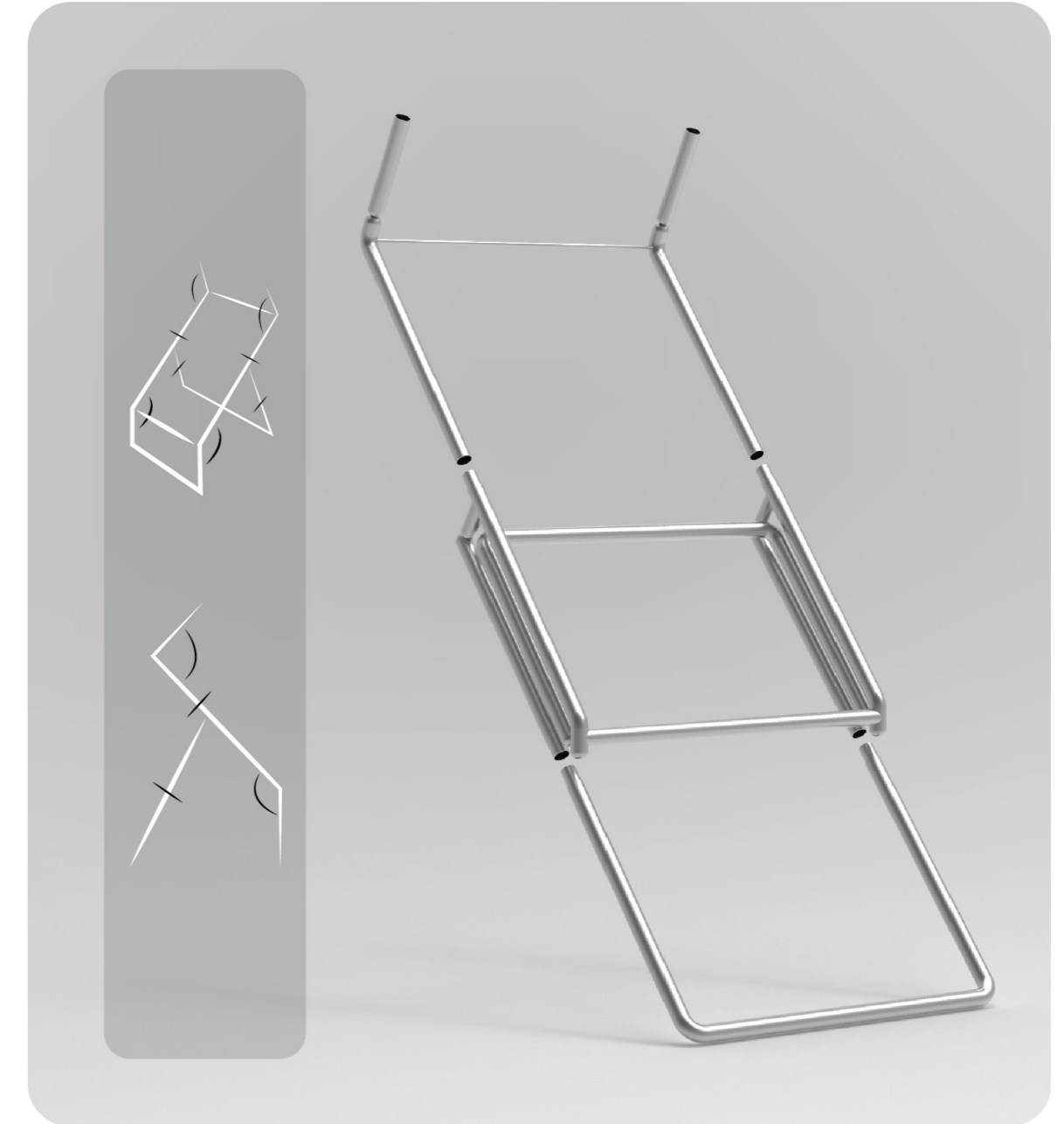
Figura 86 Alternativa 5 para Estructura Principal Mixta. Elaboración propia.
