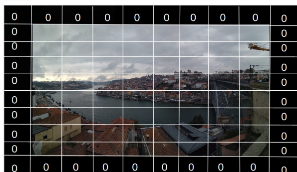
Figura 2.4: Ejemplo de zero-padding. Se agregan ceros alrededor de la imagen para realizar el filtrado.
