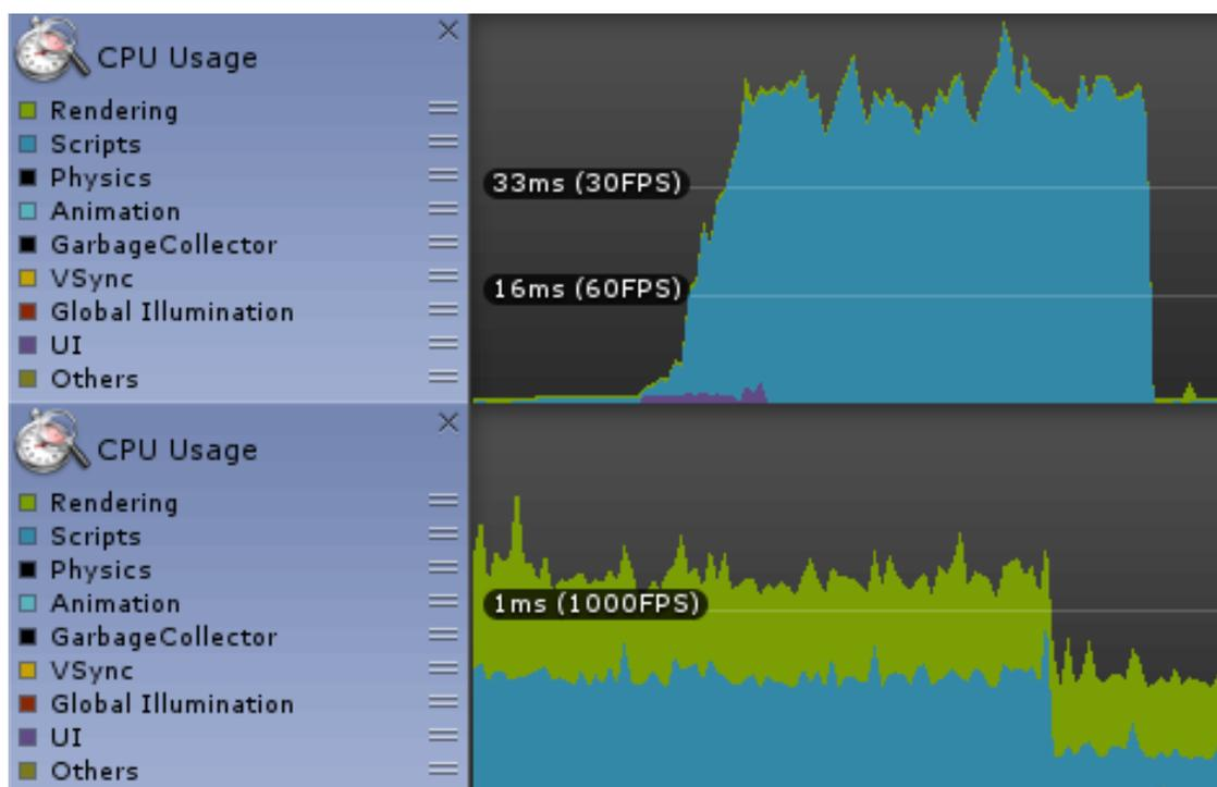
Figura 4.22: Diferencia de rendimiento causada por el uso de pooling al crear y destruir 100 baldosas cada frame. La imagen superior (a) muestra los resultados sin pooling y la inferior (b) los resultados con pooling.
