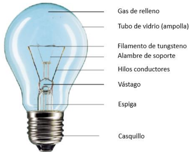
Figura 2.2: Elementos constitutivos de una lámpara incandescente. Fuente [6]
