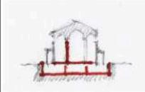
Esquema de intervención actual sobre el proyecto: el edificio existente se interviene desde abajo, posándose sobre una nueva estructura que la aísla del suelo y permite conservar su lógica estructural original.
