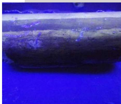
**Imagen 18:** Rayos uv sobre muestra de nevadura de bóveda de crucería ubicada sobre el muro norte.
