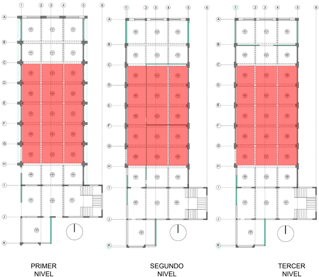
Figura 64: Esquema losas críticas en bloque A, Escuela de Minas. Fuente Elaboración propia.
